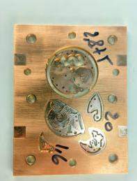
2. Usinage : à l'aide de machines à commandes numériques opérées par des usineurs, la matière devient composant.
