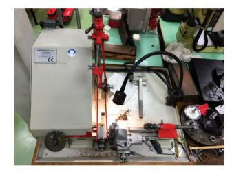
Le tour Schaublin 70 : très connu du monde horloger, il nous est utile pour réaliser des axes et des pièces cylindriques plus grosses, à l'aide des chariots croisés ; il est équipé d'un dispositif pour tailler des roues de façon traditionnelle (denture taillée à la main).
